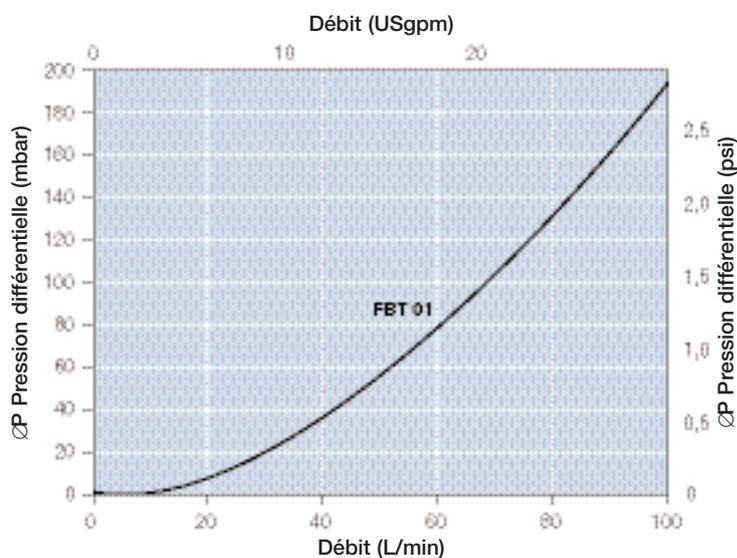
\* les données typiques débit/perte de charge se réfèrent uniquement au corps vide, pour de l'eau à 20 °C (68 °F). Pour les autres liquides, multipliez la perte de charge du corps de filtre par la gravité spécifique du fluide.
