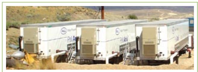
Die mobile Wasseraufbereitungsanlage von Pall besteht aus einem kompletten vollautomatischen Pall Aria™ MF Membransystem. Die Aufstellung erfolgt im Trailer oder Container. Unter der Voraussetzung, dass der Einsatzort entsprechend vorbereitet ist, ist das System bei geringem Aufwand binnen weniger Stunden betriebsbereit.
