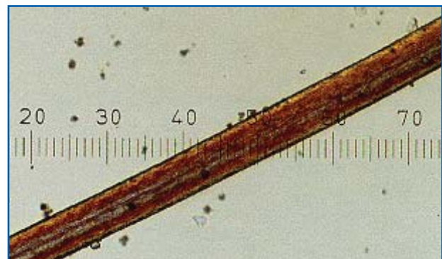
Pelo humano (75 \mu\text{m} ), partículas (10 \mu\text{m} ) a 100x (14 \mu\text{m} /división).
