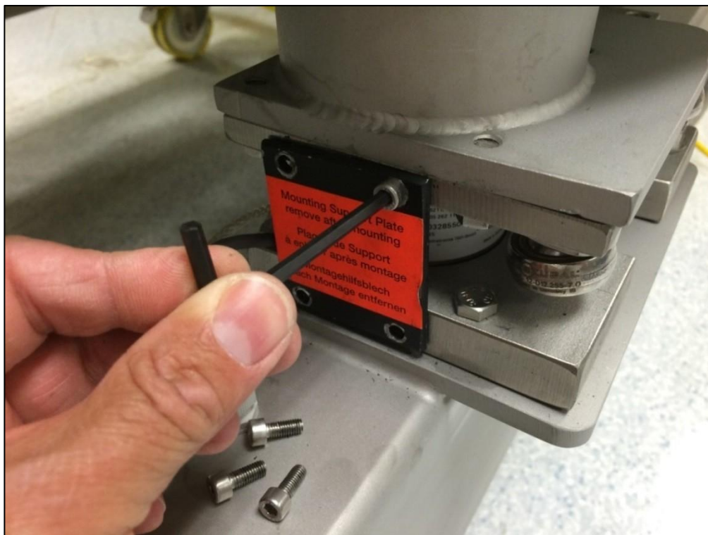
Abbildung 1. Entfernen der Transportplatte von der Wägezelle
