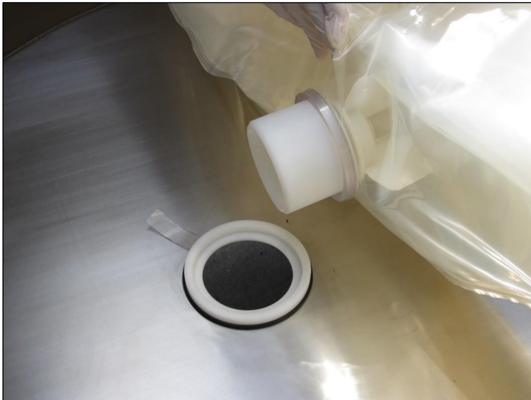
Abbildung 13. Ausrichten des Haftmagnets mit der Verbindung Antrieb-Biocontainer
