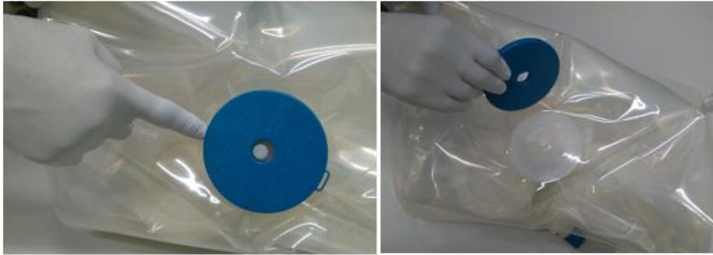
Abbildung 11. Entfernen der Versandscheibe
