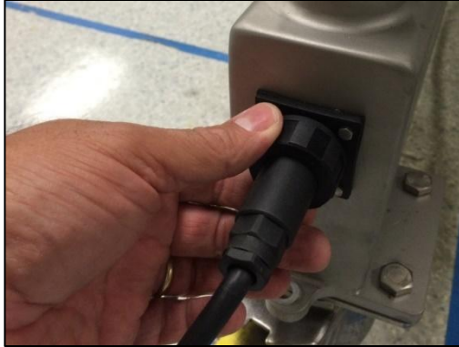
Abbildung 5. Anbringen des Netzkabels der Wägezelle
