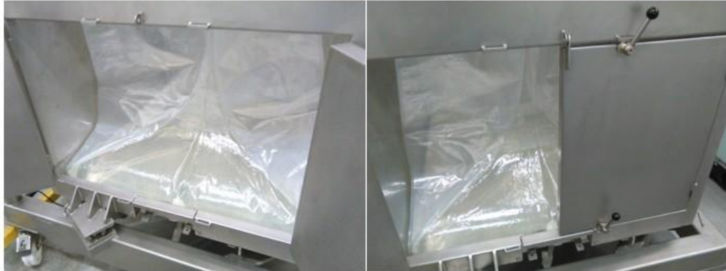
Abbildung 19. Flüssigkeitsstand erreicht die Türschwelle
