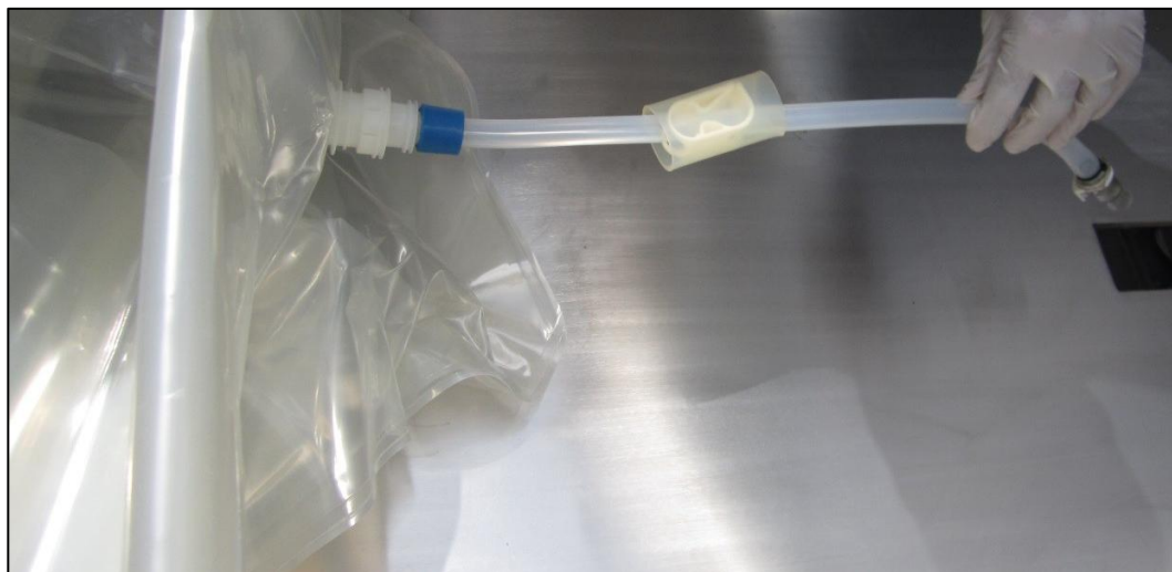
Abbildung 14. Positionieren des Abflusses des Misch-Biocontainers
