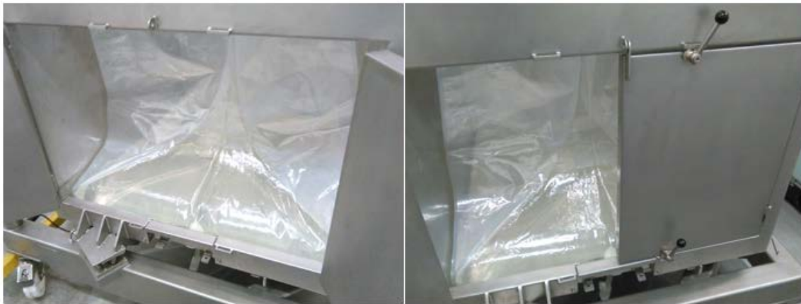
Figure 19 : Niveau de liquide atteignant les rebords des portes
