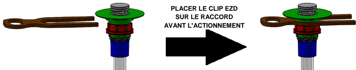
Figure 16 : Installation du clip EZ Drain
