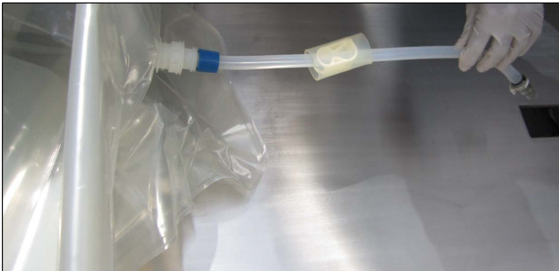
Figure 14 : Positionnement du tuyau d'évacuation du bioconteneur de mélange
