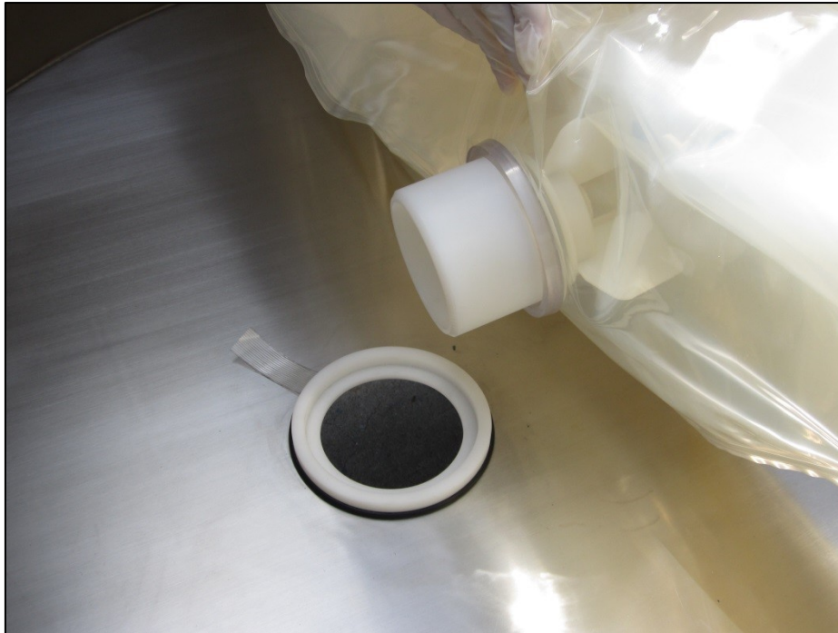
Figure 13 : Alignement du cylindre magnétique avec l'interface de l'unité d'agitation du bioconteneur
