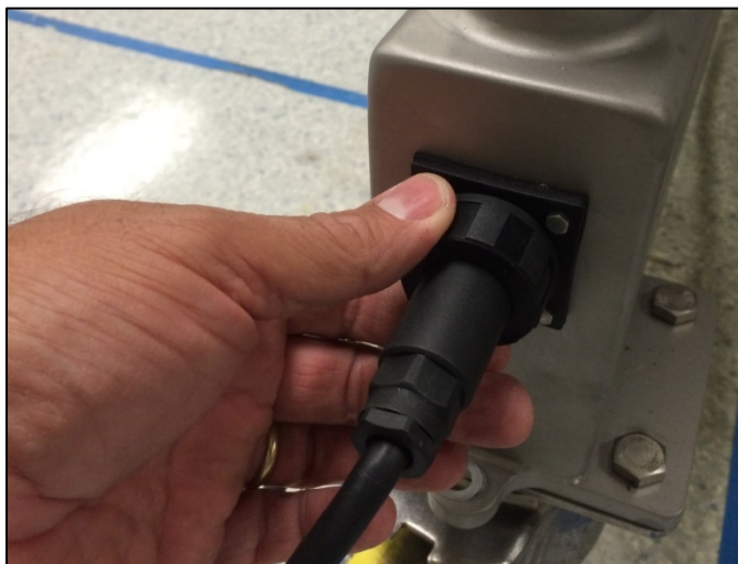
Figure 5 : Fixation du cordon d'alimentation de la cellule de charge
