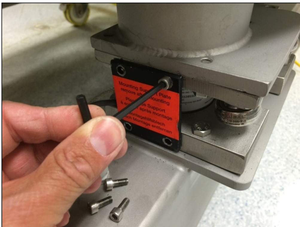
Figure 1 : Retrait de la plaque de transport de la cellule de charge
