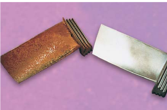
Слева: На турбинной лопатке откладывается осадок.
