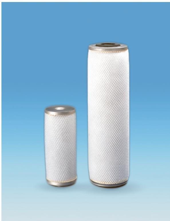
“リバース・ウルチポア”は、空気、ガス中からの油分、水分除去用に、20年以上にわたる数々のラボテストと現場テストを経て開発されたフィルターカートリッジです。フィルターメディアは、ポール社が独自に開発した二層の頑丈な構造で、ろ過面積を大きくするためにプリーツ状になっています。さらに、フィルターメディアの破損や圧力損失の増加によるろ過効率の低下を防ぐために、内部パンチング・メタルコアとパンチング・メタルサポートがメディアを保護しています。フィルターカートリッジの一番外側には、一度捉えた油分、水分を再び空気、ガス中に飛散させないように、小さな粒子を大きく合体させて、フィルターから排出する働きをするポリエステルフォームが巻かれています。
