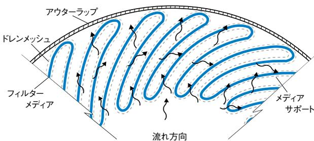
“ウルチプリーツ・ハイフロー”システムは、毎分1m<sup>3</sup>を超える大流量用途や粘性流体のろ過、更には数か月以上のろ過寿命の要求される用途に最適です。1本当たり最大1,900 L/minの処理が可能で、細かいろ過精度などの点から下記のような広い用途での使用が可能です。また、フィルターはサポートコアのない設計になっており、廃棄ボリュームが従来の1/4に低減されます(当社比)。
