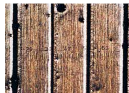
Традиционный материал щелевого фильтра – приблизительная объемная пористость = 4 %.
