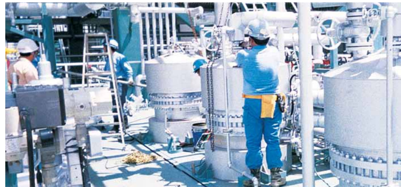
Промываемые обратным потоком фильтры Pall для защиты катализаторов и удаления микрочастиц катализатора из нефтешлама ФКК обеспечивают высокую окупаемость инвестиций нефтепереработчиков.
