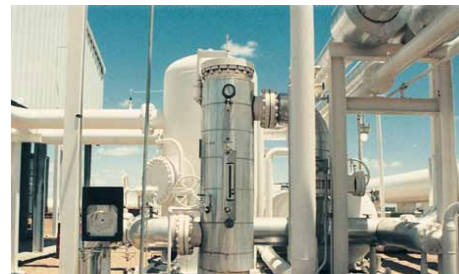
Коалесцеры Pall Жидкость/ Газ удаляют жидкие и механические примеси из водорода и топливного газа, защищая турбины и горелки.
