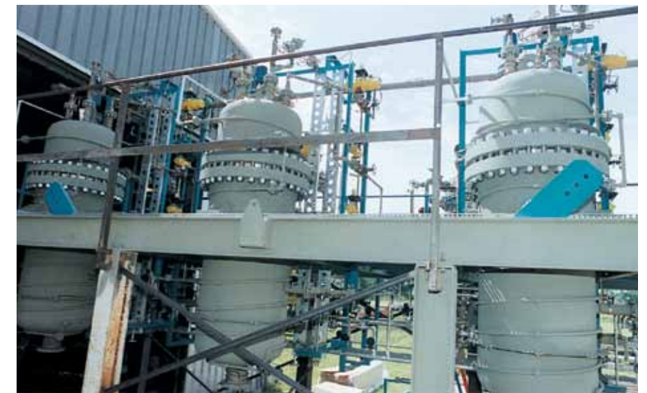
Фильтрующие системы Pall, промываемые обратным потоком, отличаются от других технологий очистки (например, электростатических сепараторов и гидроциклонов) гораздо меньшей стоимостью эксплуатации и обслуживания.
