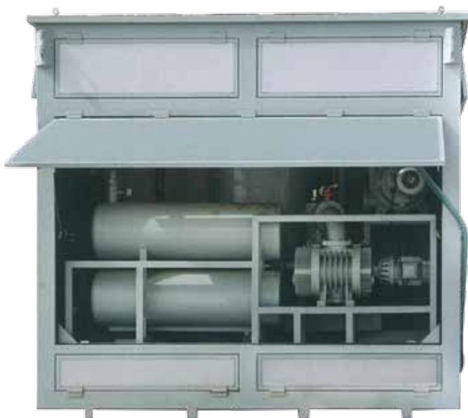
HEPT 特高压变压器油专用真空滤油机
