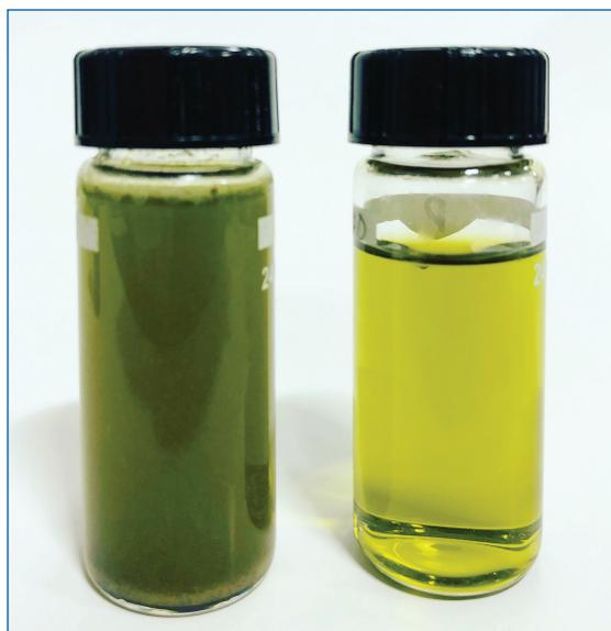
Figura 7: Amostras de óleo de cannabis produzido em um processo de extração por etanol. Óleo bruto (esquerda), depois da filtração com a tecnologia SUPRA para clarificação (direita).
