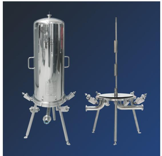
Abbildung 1: WFSZ Gehäuse – Die Höhe der zentralen Spindel kann je nach Anzahl der SUPRADisc II oder AKS Module, die das Gehäuse aufnehmen soll, geändert werden. Ein Adaptersatz ermöglicht die Aufnahme von SUPRApak Modulen.
