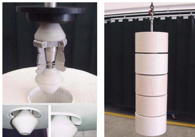
I ganci vengono applicati alla base della pila di moduli SUPRApak per facilitare la manipolazione
