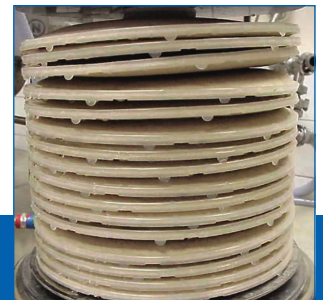
Déformation des cellules après le traitement à la chaleur
