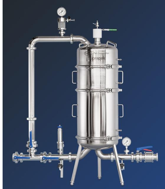
Рисунок 6: Корпус SUPRApak L-421 (4-ярусный) со стандартными принадлежностями может эксплуатироваться с 1,2,3 или 4 ярусами картриджей.
