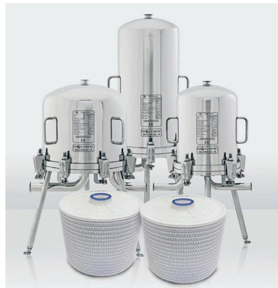
Рисунок 3: Корпуса Pall WSFZ для модулей SD II обеспечивают гибкость производства. Устанавливая центральные внутренние колонны разной длины, можно выполнять фильтрацию, используя 25, 50, 75 и 100% пропускной способности. Специальные адаптеры позволяют осуществлять переход на модули SUPRApak по мере увеличения выпуска продукции.
