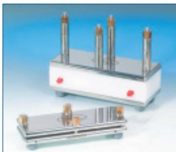
Piccoli sistemi di filtrazione a flusso tangenziale (TFF) di laboratorio sono impiegati nello sviluppo di nuovi prodotti e nelle prove di fattibilità. Si prega di consultare Pall per le soluzioni a flusso tangenziale in scala industriale
