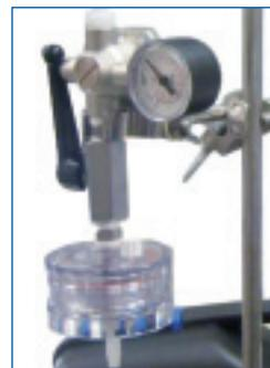
Il kit di analisi Silt Density Index — consente un semplice monitoraggio della qualità dell'acqua
