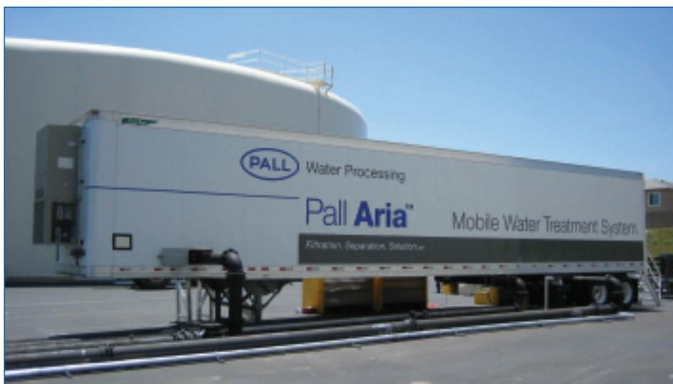
Impianti pilota che per dimensioni possono essere classificati come da laboratorio e come veri e propri processi industriali sono utili per l'esecuzione dei test e lo sviluppo dei processi. L'unità Pall Aria Mobile Water Treatment fornisce una soluzione "chiavi in mano" per gli impianti pilota della tecnologia Pall Aria e per la comprensione dei vantaggi ad essa collegati. La disponibilità degli impianti pilota è globalmente diversificata; si prega di consultare Pall per le varie possibilità.
