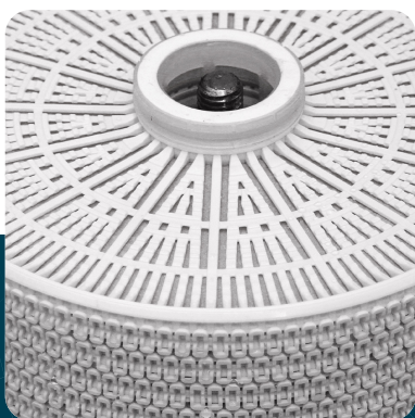
Abbildung 9: Keine Beschädigung der SUPRAdisc II Module
