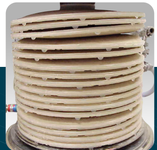
Abbildung 4: Verformungsprobleme bei klassischen Modulen
