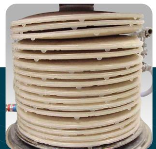
Abbildung 4: Verformungsprobleme bei klassischen Modulen
