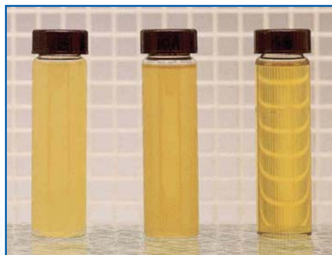
Remoção de água livre em um óleo de turbina comum: o aspecto transparente mostra a inexistência de água livre
