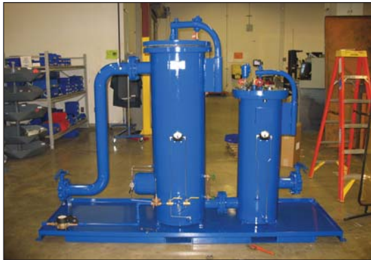
Рис. 3: Типичная система фильтрации с пропускной способностью 1200 л/мин, состоящая из предварительного фильтра и фильтра-коалесцера, используемая в горной промышленности.
