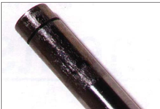
Рис.: Абразивный износ плунжера инжектора
