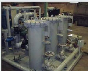
Filtros de alta pressão usados em sistemas de controle de manômetros automáticos.
