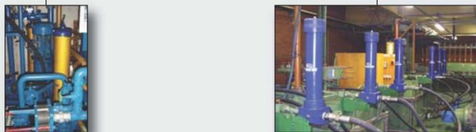
Purificador de óleo para sistemas hidráulicos e de lubrificação
