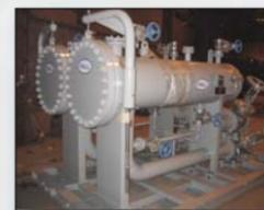
Sistema de membranas cerâmicas usado para tratar água residual de emulsões derivadas de operações de laminação a frio
