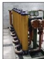
Carcaça de filtro em multiseção usada para sistema de lubrificação de laminação em barra/fio
