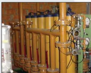
Purificador de óleo de alto volume usado em sistema de lubrificação de laminador de placas de 2000 mm
