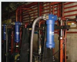
Filtração do sistema hidráulico em laminadores de tiras a quente
