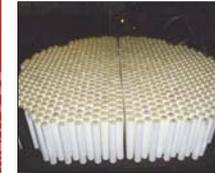
Filtración recirculante (lazo de riñón) utilizada para prensa de extrusión de aluminio
