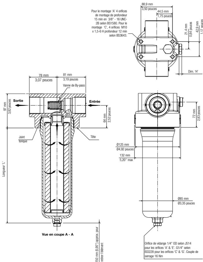
Tableau 1 – Types d'orifice et dimensions du corps
