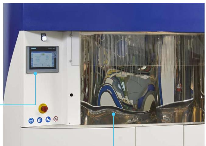
Analysenraum mit elektropolierter Edelstahloberfläche (Ra = 0,02 µm max.)
