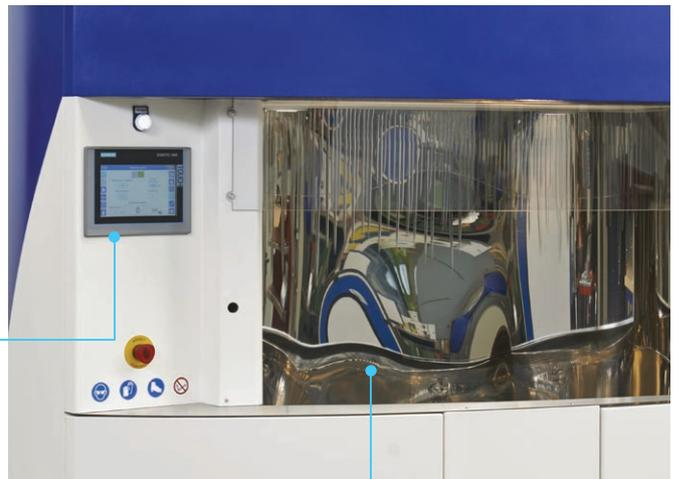
Boîtier d'extraction en inox, état de surface poli miroir au fini super réfléchissant (Ra = 0,02 µm max.)
