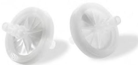
37 mm バクテリアエアイベントは、コンパクトなベントフィルターで、ポアサイズ1  $\mu\text{m}$ の疎水性ガラス繊維のラミネートメンブレンを採用しており、フィルター材質から派生するガラス繊維の混流を低減しています。ガンマ線照射済みの滅菌タイプと未滅菌の2種類を選択できます。
