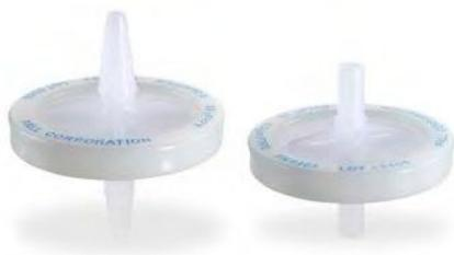
アクロ50 ベントフィルター (PTFE)は、空気やガスの無菌化や製薬研究や実験プロセスにおけるバクテリアのエアイベントとして設計されています。フィルターのポアサイズは、0.2, 0.45, 1  $\mu\text{m}$ の3種類から選択できます。未滅菌タイプでオートクレーブ滅菌ができ、使用前後での完全性試験も可能です。
