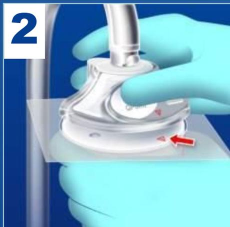
ドッキングステーションとフィルターカプセルの三角印を合わせます。
