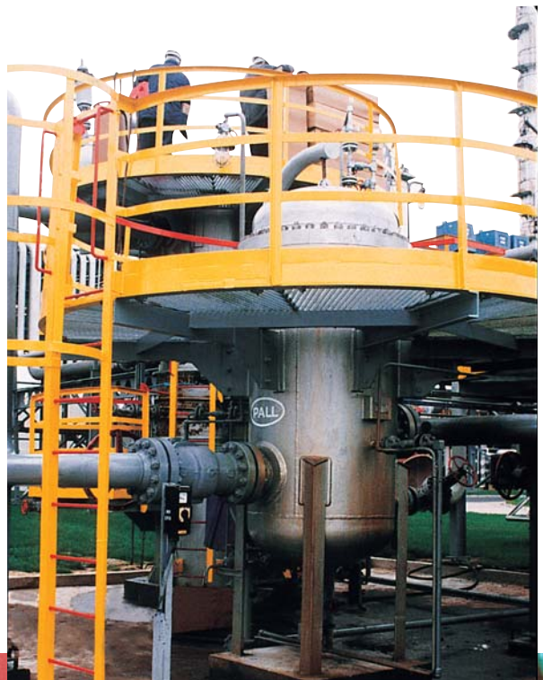
Вертикальная система коалесцеров Аквасеп Плюс Жидкость/Жидкость удаляет воду из дизеля.
