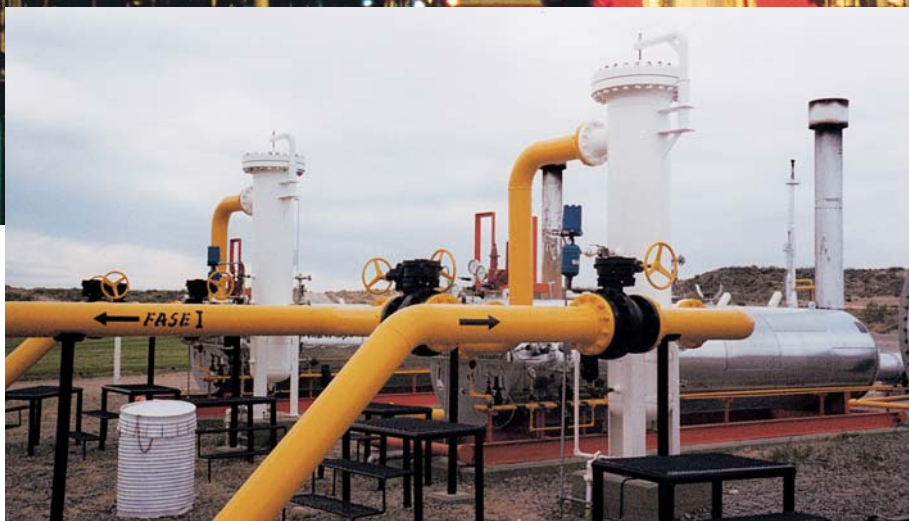
Система коалесцеров Сепрасол Жидкости/Жидкость защищает компрессор.
