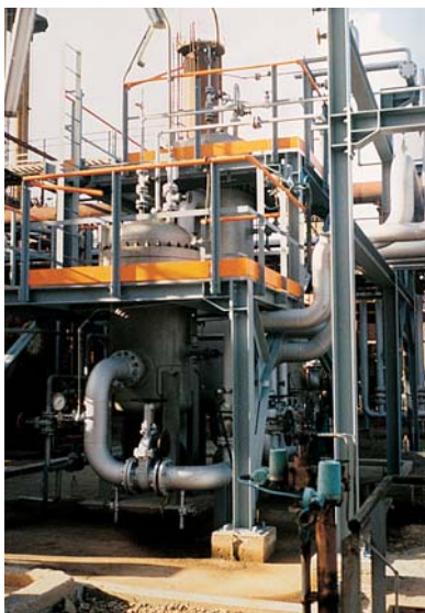
Вертикальная система коалесцеров Аквасеп Плюс Жидкость/Жидкость удаляет воду из керосина.
