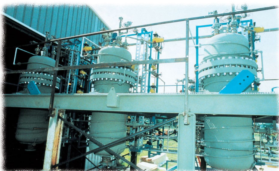
ポールのバックウォッシュシステムは、FCCスラリーオイル中の微細な触媒をほぼ完璧に近く分離することができます。液体サイクロンや電気集塵機に比べ、高効率、省スペース、省コストを実現します
