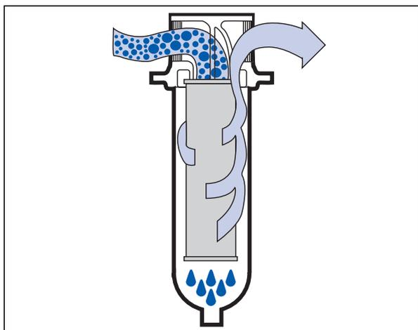
“リバース・ウルチポア”は、空気、ガス中からの油分、水分除去用に、20年以上にわたる数々のラボテストと現場テストを経て開発されたフィルターカートリッジです。フィルターメディアは、ポール社が独自に開発した二層の頑丈な構造で、ろ過面積を大きくするためにブリーツ状になっています。さらに、フィルターメディアの破損や圧力損失の増加によるろ過効率の低下を防ぐために、内部パンチング・メタルコアとパンチング・メタルサポートがメディアを保護しています。フィルターカートリッジの一番外側には、一度捉えた油分、水分を再び空気、ガス中に飛散させないように、小さな粒子を大きく合体させて、フィルターから排出する働きをするポリエステルフォームが巻かれています。
