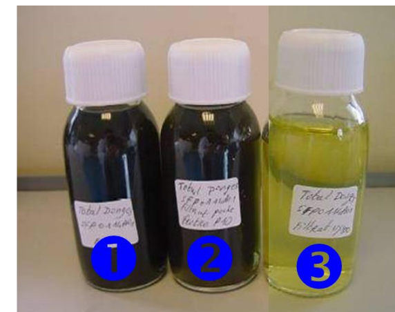
熱交換器を閉塞する 黒色固形異物
