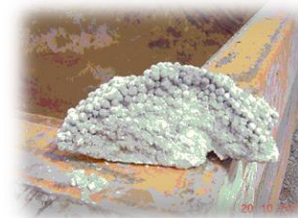
劣化した吸着剤
