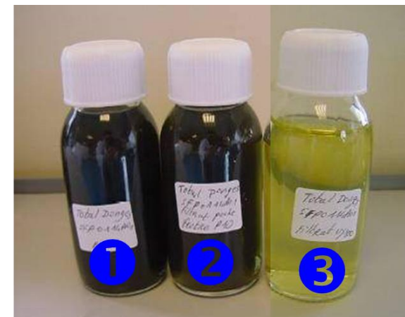
熱交換器を閉塞する 黒色固形異物
