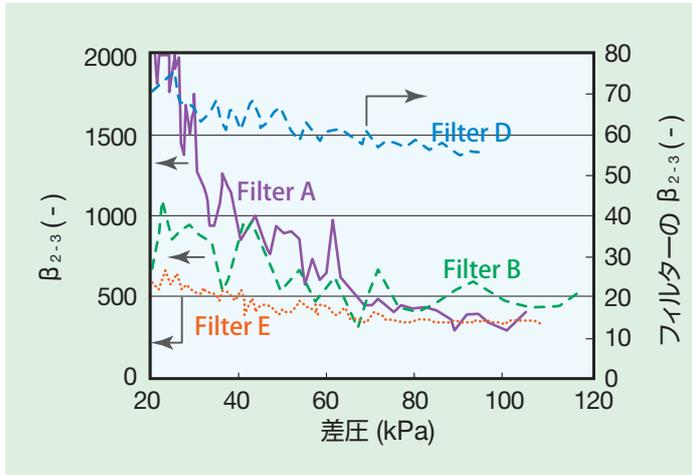
図11：メチルセルロース水溶液のろ過において差圧がフィルターA、B、D、Eの $\beta$ 値に及ぼす影響
