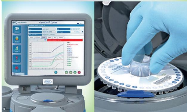
出荷検査として、酵母の残存が翌日には判定可能になる他、一連の製造プロセスの中で、多数の醸造用酵母や菌種が含まれるサンプルからでも、例えば *Brettanomyces* 属菌など、“特定の変敗性菌種”を正確に、最短2時間で検出、同定することが可能です。このため、出荷判定の日数短縮や、製造工程での異常発生迅速対応が可能となります。
