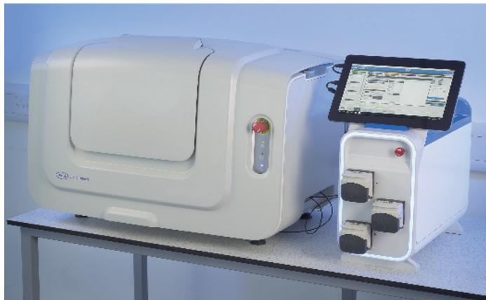
独自の二軸攪拌による高い攪拌効率から達成できる高い酸素移動速度によって、生細胞数、生細胞率、発現レベルが高く、従来のロッキングシステムよりも優れた性能を発揮します。
