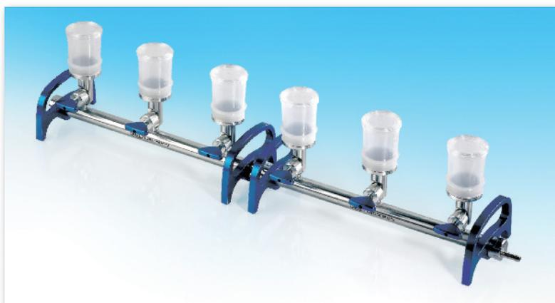
メンブレンフィルター（MF）法を用いてサンプル溶液の微生物学的検査を行うお客様のご要望にお応えして、デザインを一新しました。
