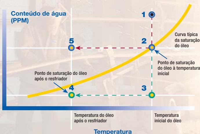
**O controle da água dissolvida e também da água livre no reservatório é importante para garantir a ausência de água livre durante a operação. Com o purificador Pall HLP6, isso é feito de forma eficiente, fácil e confiável.**
