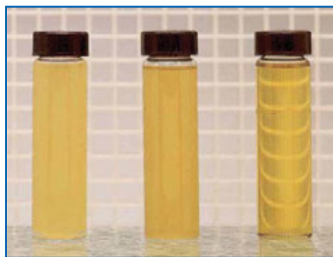
Удаление воды из стандартного турбинного масла: прозрачность масла указывает на отсутствие свободной воды
