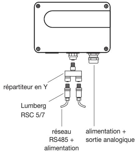
**Convertisseur RS232/485 :** Pour adapter l'interface RS232 du PC au protocole réseau RS485, un convertisseur de signal est nécessaire.
