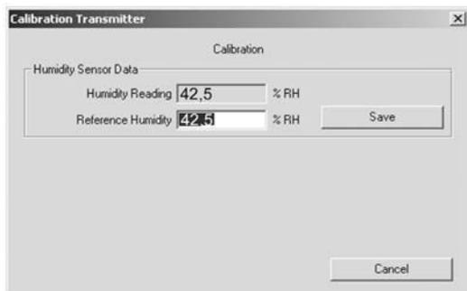
**1-point calibration Humidity (Étalonnage à 1 point de l'humidité) :**
