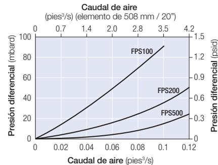
\* Para una viscosidad del aire de 0,018 cP. Corrección para otros gases: lectura del gráfico x
