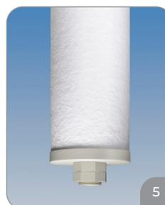
5. 1つめのロックナットをメインコアの底のねじ山にねじ込みます。メインコアの上部プレート(エンドキャップ)とボトムプレートがコアレスサーメディアにしっかりと食い込むように締めます。2つめのロックナットを、1つめのロックナットに突き当たるまで締めこみます。
