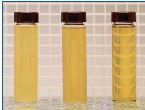
Eliminación del agua libre en aceite de turbina típico: el aspecto brillante y transparente indica la ausencia de agua libre
