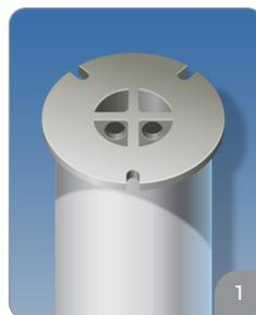
1. Use os orifícios fornecidos na parte superior da cruz do adaptador para puxar o adaptador (com o meio coalescedor) manualmente da placa de filtro.
